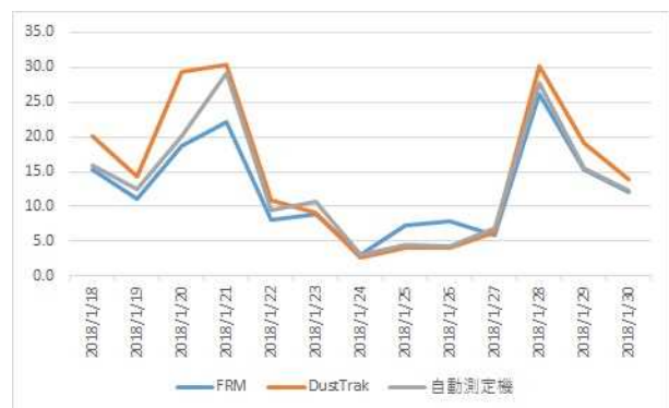
図5 FRM2025i，DustTrak，自動測定機の比較 （単位： \mu\text{g}/\text{m}^3 ）
