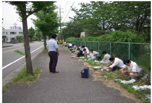
図1 道路交通振動の測定実習（初級講習）
