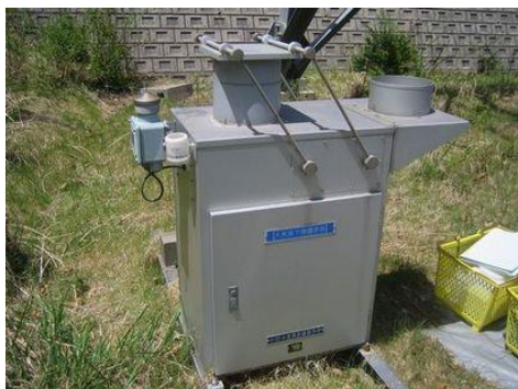
写真 1 降水時間開放型降水採取器
