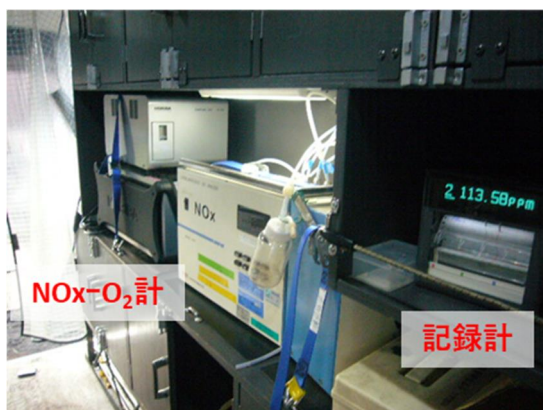
写真 3 ばい煙測定車内の主な測定機器 (2)
