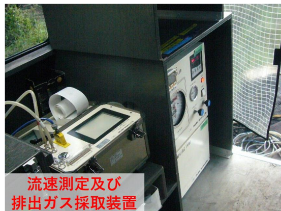
写真 2 ばい煙測定車内の主な測定機器 (1)
