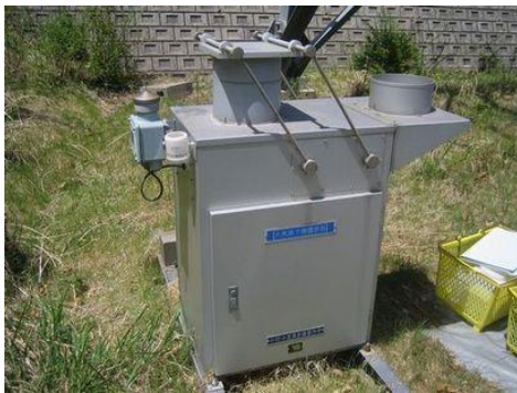
写真 1 降水時開放型降水採取器
