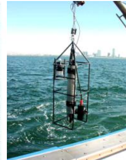
写真2 多項目水質測定装置
