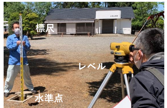
水準測量の作業のようす
