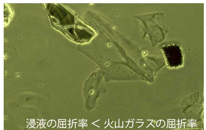
図3：火山灰中の火山ガラスの屈折率の測定の様子
