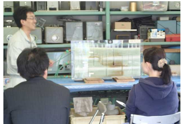
地層の模型を使って汚染が地下深く浸透し 地下水が汚染されていく過程を観察
