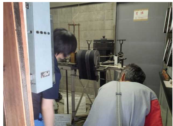
ウーヘルト地震計で煤紙を使った地震記 録紙に実際に波形が記録される様子を観察
