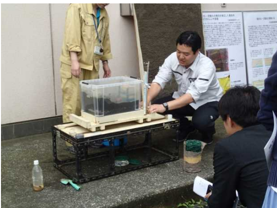
実験装置を手で揺らして中の砂が液状化し模型の 建物の沈下や地下タンクの浮上する様子を観察
