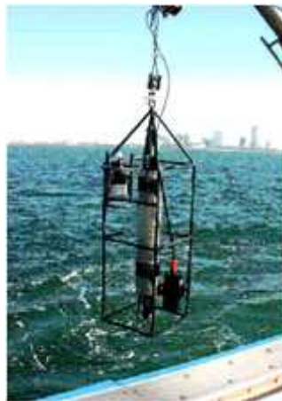
写真4 多項目水質測定装置
