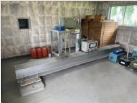
千葉県 の 地盤沈下観測井
