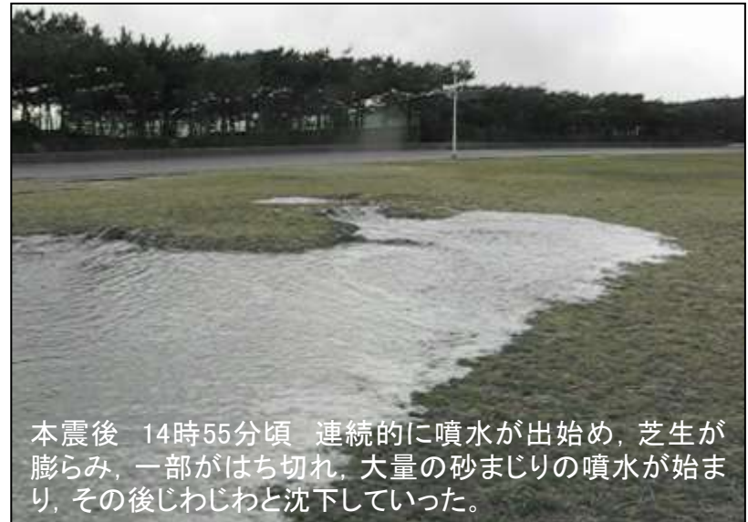
本震中14時51分30秒すぎ頃に同じ場所で約5秒周期の最大波高数十cmの波打ちが発生し、噴砂・噴水が始まる。砂まじりの黒い噴水は高さ50cm程度。
