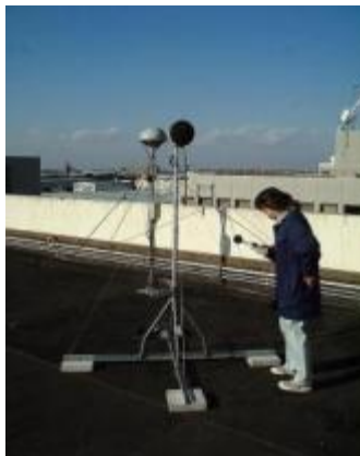
写真 航空機騒音自動測定機(木更津市貝渕局) (左:マイクロホン、右:騒音計・データ処理装置等)
