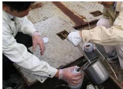
分析試料として汚泥を採取している様子
