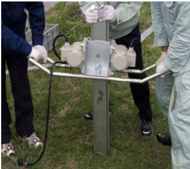
ハンディジオスライサーによる地層の採取
