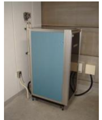
写真 航空機騒音自動測定機(木更津市貝渕局) (左:マイクロホン、右:騒音計・データ処理装置等)
