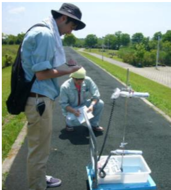
サーベイメーターによる 空間放射線量の測定
