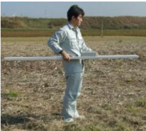
電磁探査装置による廃棄物層の調査
