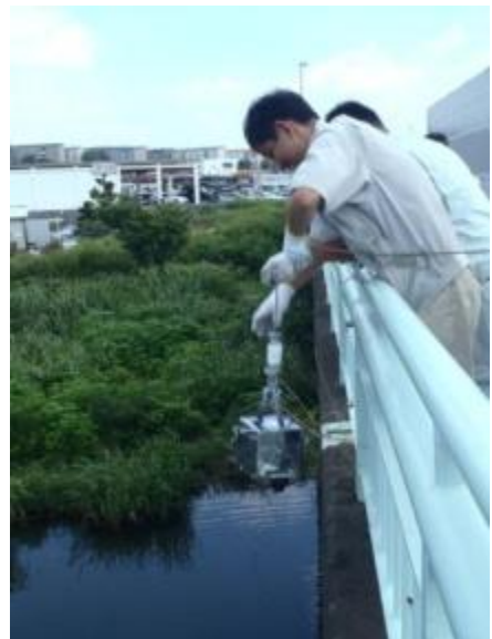
エクマン・バージ型採泥器による 河川底質の採取
