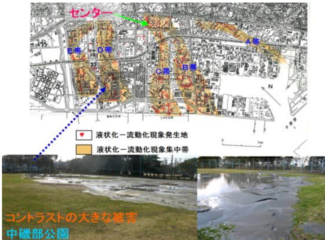
千葉市美浜区埋立地における被害の帯状分布の状況(上図) まだら状の被害の例(下の写真)
