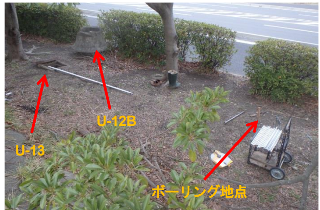
図2 ボーリング地点付近の水準点の状況。U-13は通常の水準点で、基礎の深さは約1m。U-12Bは基礎の深さが10mある水準点のため丸い柱が抜け上がっている。
