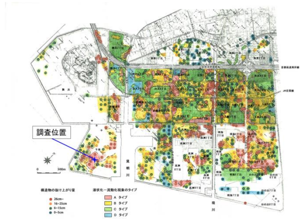
図1 調査地と周囲の太平洋沖地震時の液状化－流動化現象のタイプの分布状況 2) 。タイプ区分については、表1を参照。
