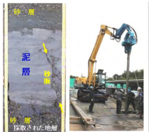
図 2 ACE ライナーによる地層採取状況と、採取した地層の断面 1)
