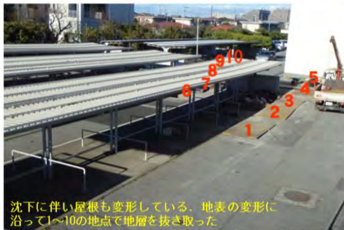
図 2 ACE ライナーによる地層採取状況と、採取した地層の断面 1)
