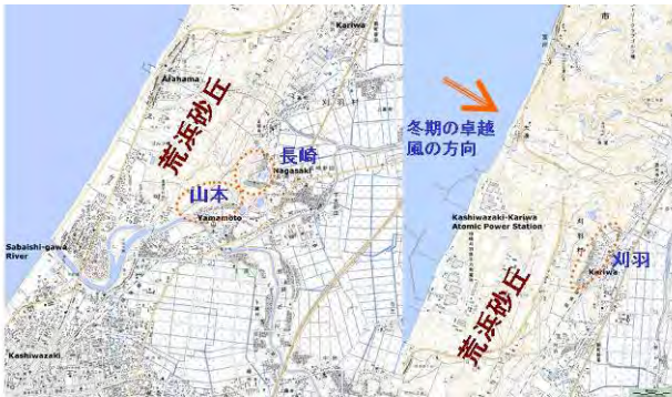
図1 荒浜砂丘内陸側斜面の液状化－流動化被害(オレンジ点線内)の分布
