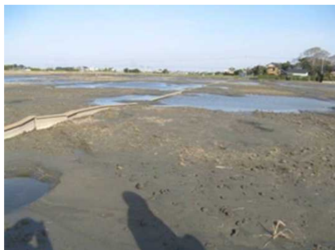
写真32 大倉新田。旧古利根川に沿う地波。波長20m程度、振幅0.5m程度と大きい(3/19)。
