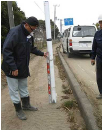
写真36 山武市蓮沼平 支柱についた津波浸水跡と、液状化—流動化により傾いた標識(3/15)。
