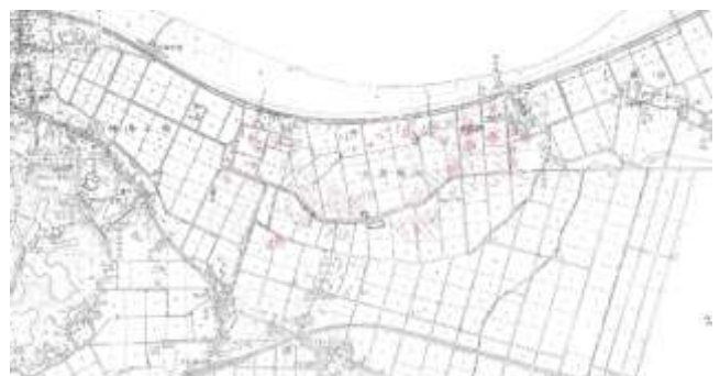
ここでは、1987年千葉県東方沖の地震に比べ広い範囲で液状化→流動化が発生している。液状化→流動化した土地は、地波が発生し低い部分には水が溜まっている。農道の方(南北方向)と平行に伸びる亀裂が見られ、電柱が傾いている。液状化→流動化の発生した
