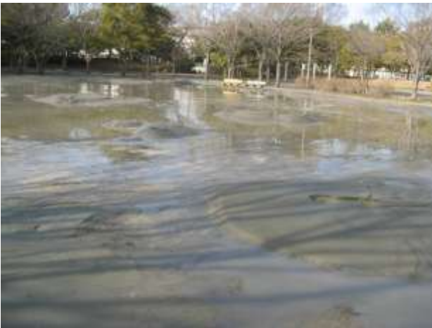
D 帯-1 中磯辺公園での大規模な噴砂と大規模な沈下
