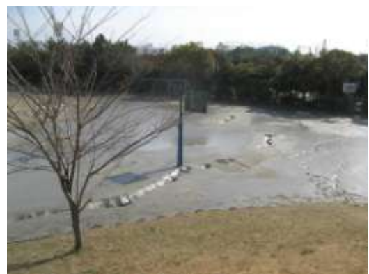
C帯-1 稲毛海岸3丁目 数十mの亀裂を伴う大規模噴砂
