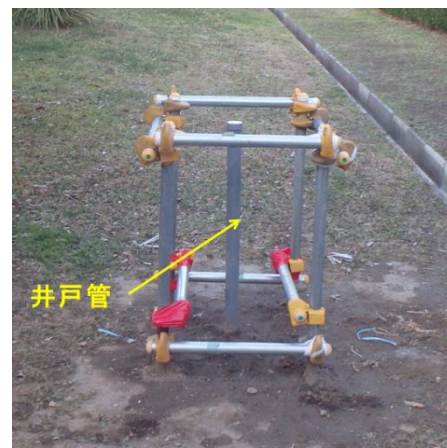
図Ⅱ-29 地上に立ち上げた地下水観測井の例
