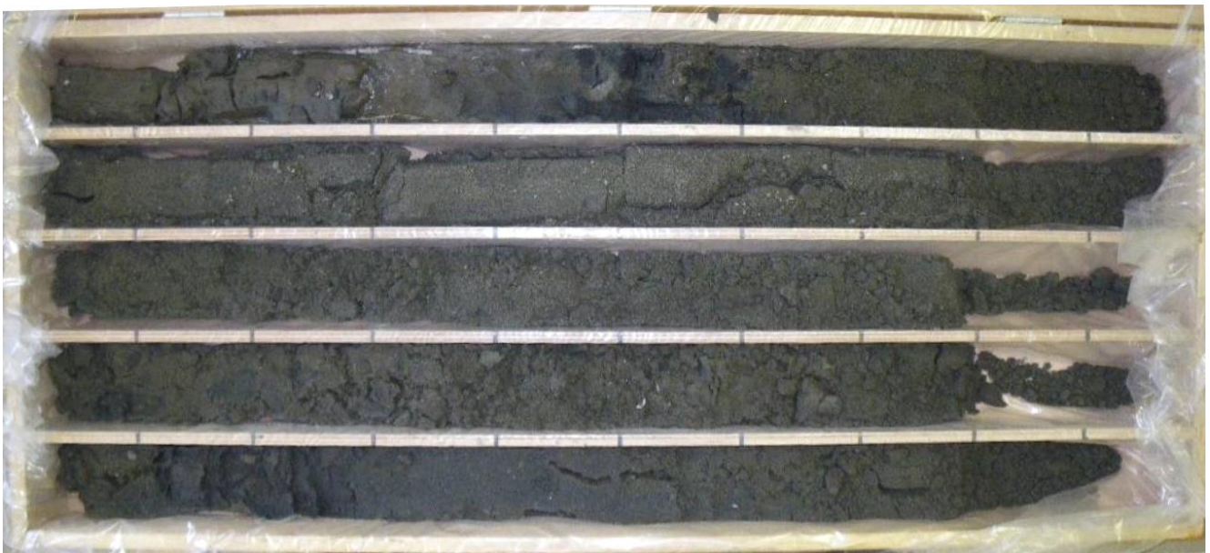
図II-8 振動で乱れたコアの例
