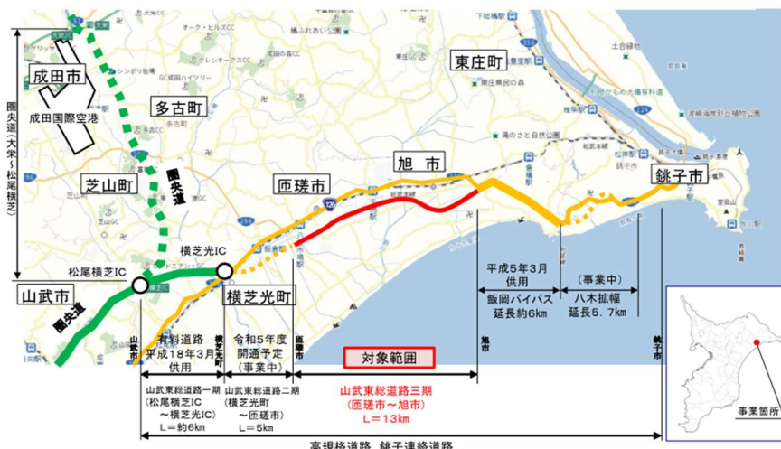
図⑧-2 銚子連絡道路整備状況
