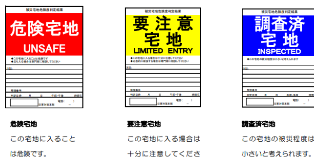
図一⑮-3 判定ステッカー
