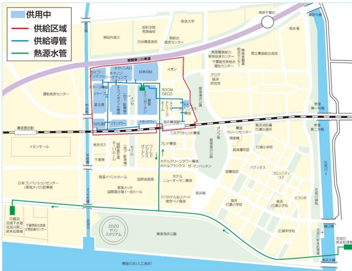
図一〇—14 再生水利用下水道事業<中水>（幕張新都心 給水地区）
