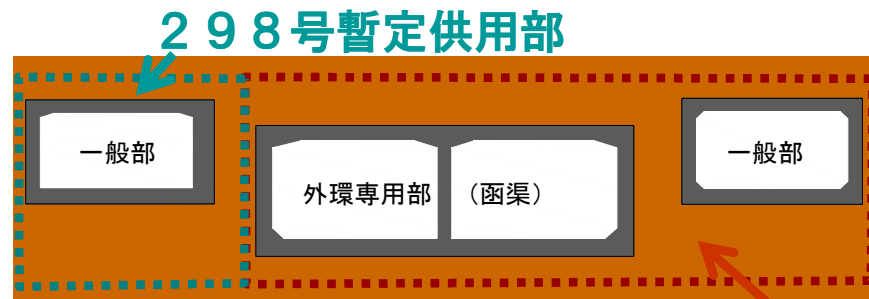
矢切函渠その5工事の工事範囲
