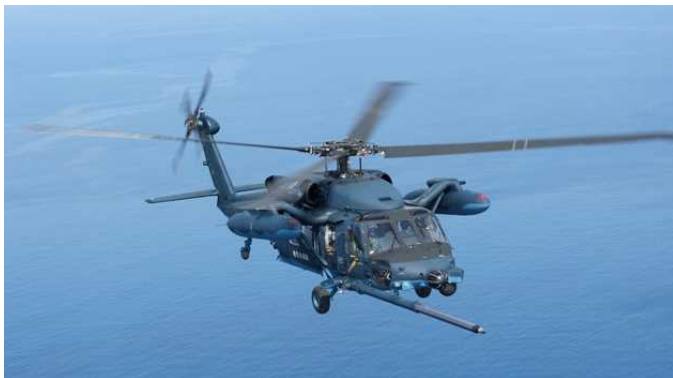
UH-60J (回転翼直径 16.40m, 全長 19.80m, 全高 5.10m)
