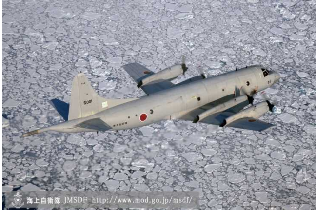
P-3C (全幅 30.37m, 全長 35.61m, 全高 10.27m)
