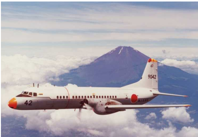
YS-11(A) (全幅 32.00m, 全長 26.30m, 全高 8.99m)
