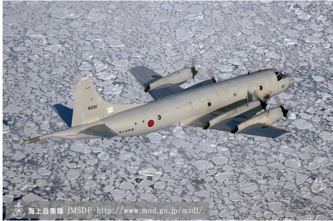
P-3C (全幅 30.37m, 全長 35.61m, 全高 10.27m)
