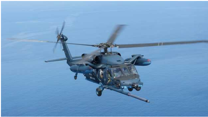
UH-60J (回転翼直径 16.40m, 全長 19.80m, 全高 5.10m)
