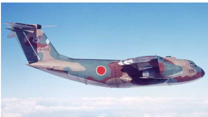
C-1 (全幅 30.60m, 全長 29.00m, 全高 10.00m)
