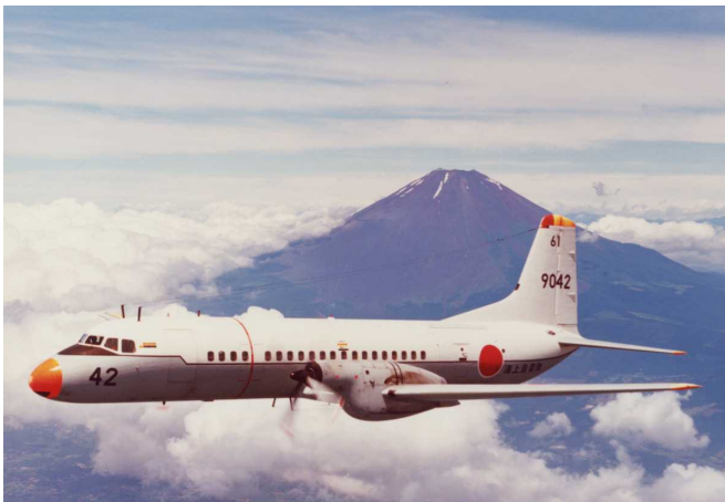
YS-11(A) (全幅 32.00m, 全長 26.30m, 全高 8.99m)
