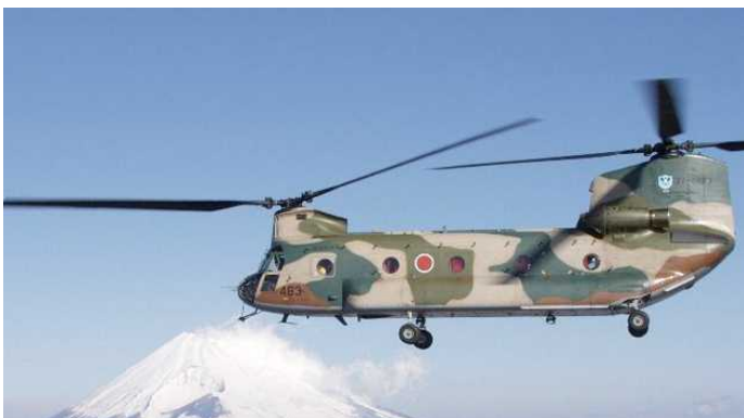
CH-47J (回転翼直径 18.29m, 全長 30.14m, 全高 5.77m)
