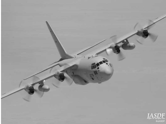
C-130H (全幅 40.41m, 全長 29.79m, 全高 11.66m)
