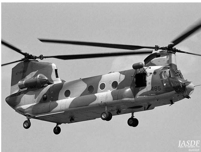
CH-47J (回転翼直径 18.29m, 全長 30.14m, 全高 5.77m)
