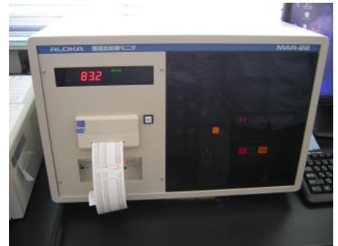
写真5-1 モニタリングポスト計測部
