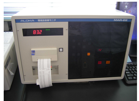
写真5-1 モニタリングポスト計測部
