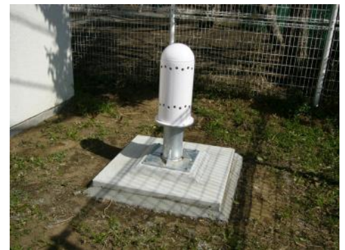
写真7-2 モニタリングポスト検出部
