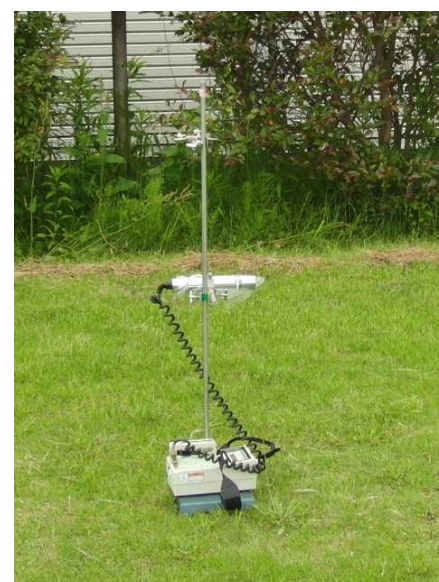
写真6-2 サーベイメータによる測定
