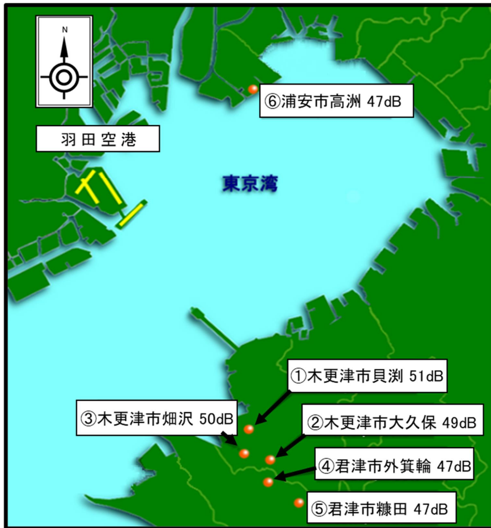
図2 羽田空港周辺における航空機騒音の固定測定局
