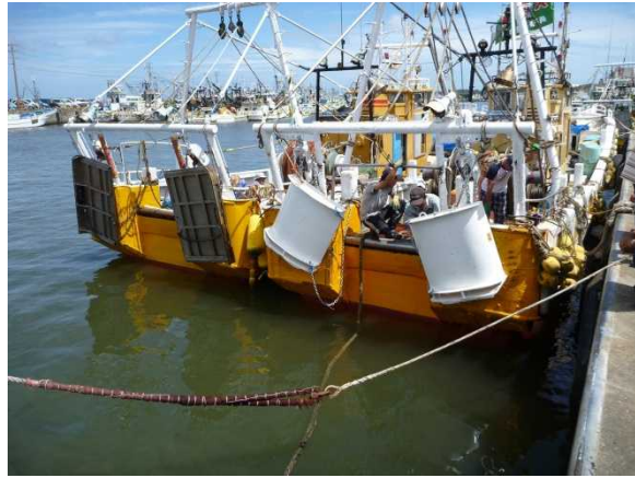
図4. 現行型オッターボード（左）と高揚力オッターボード（右）
