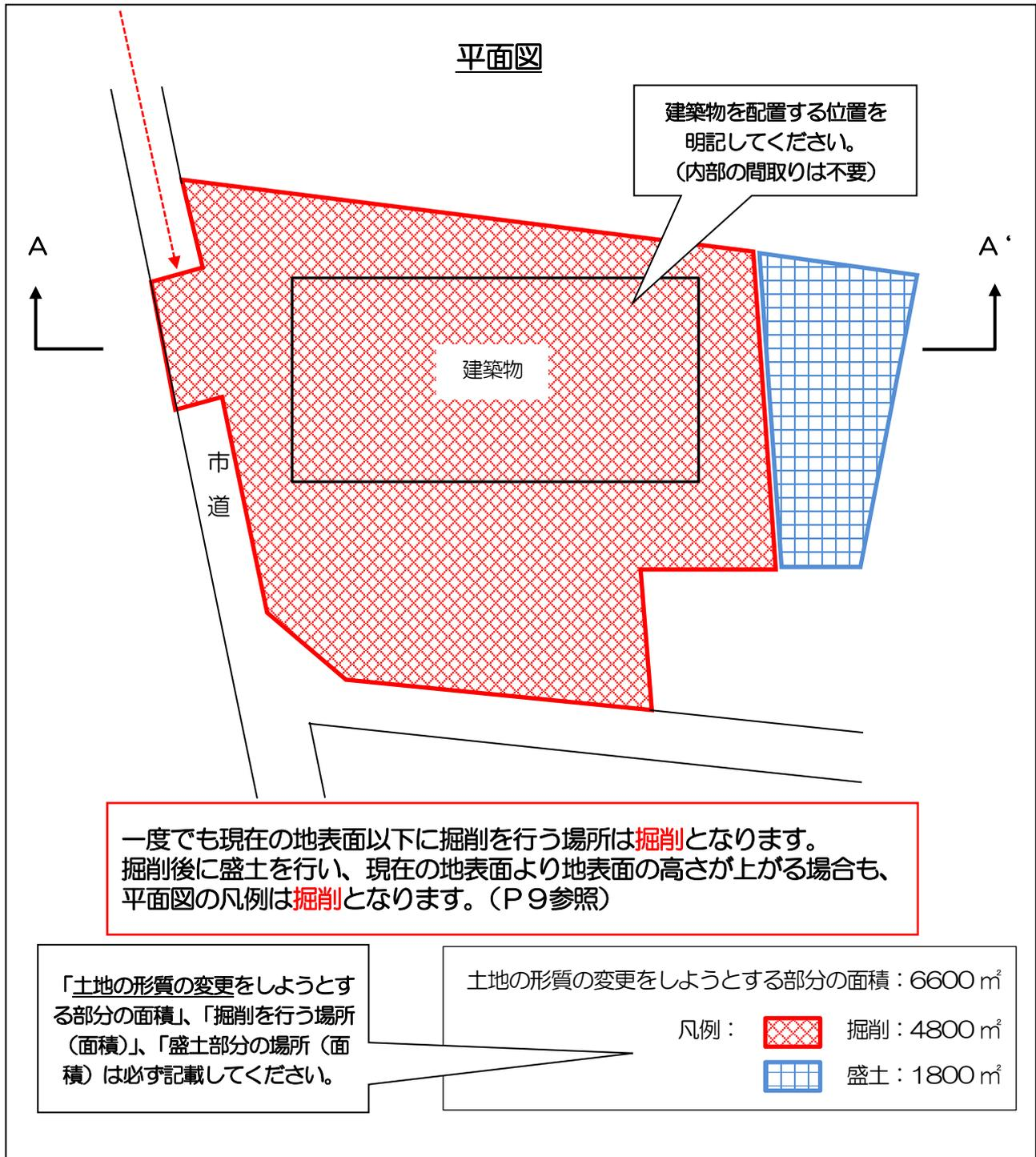
※くよくよある間違い>断面線を引いてある平面図上の掘削・盛土の別について、断面図との整合が取れていないケースがよく見受けられます！
