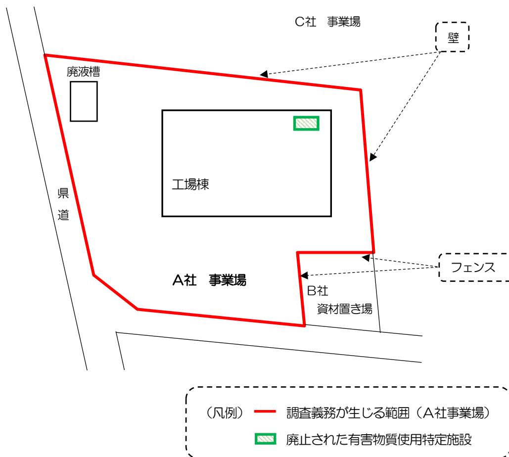
図 有害物質使用特定施設の廃止により調査義務が生じる範囲
