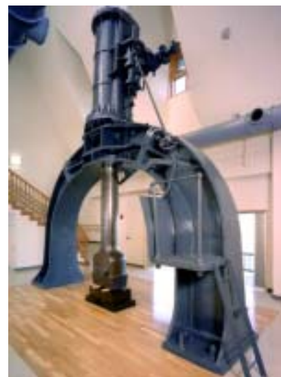
横須賀製鉄所(造船施設)の3t スチームハンマー
