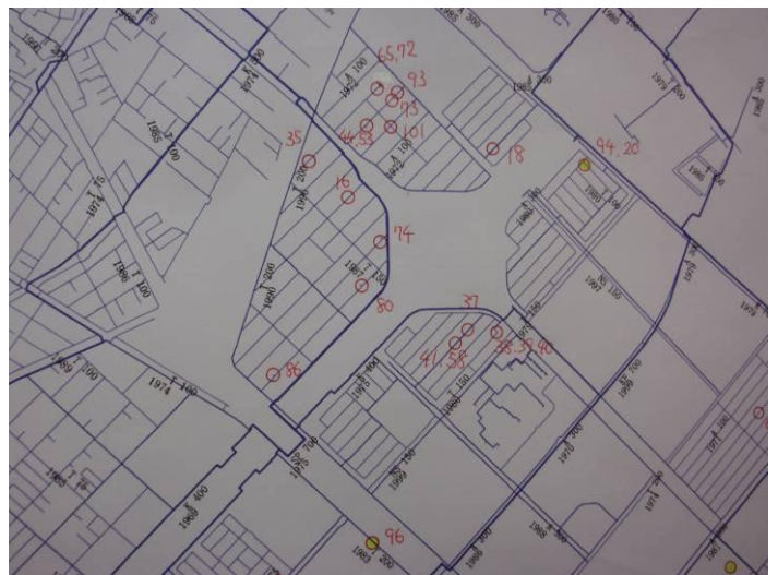
地図(配管図)での漏水・補修箇所の確認
