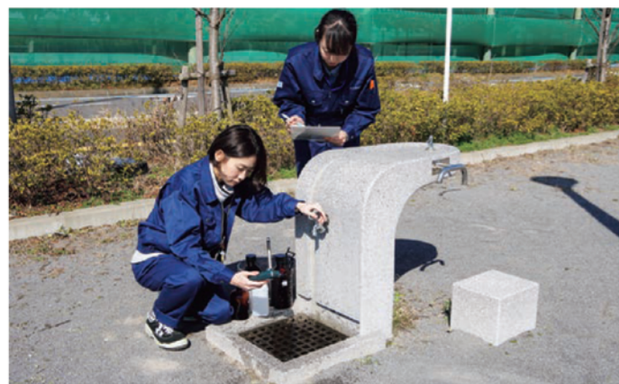
給水栓（蛇口）における水質調査
