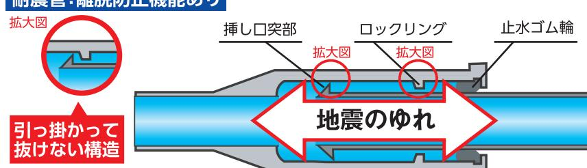
地震による揺れに対して水道管が伸縮・屈曲する。それとともに、ロックリングと挿し口突部のかかり合わせで、水道管をつなぐ継手部分の抜け出しを防ぐ
