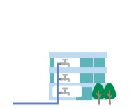
【直結直圧式給水方式】
