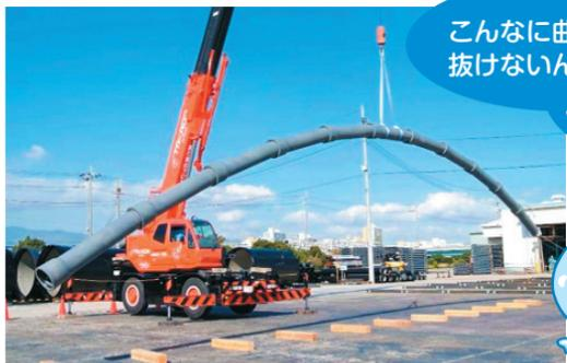
耐震継手管のデモンストレーション
