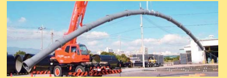
耐震継手管のデモンストレーション(クレーンによる吊り下げ)
