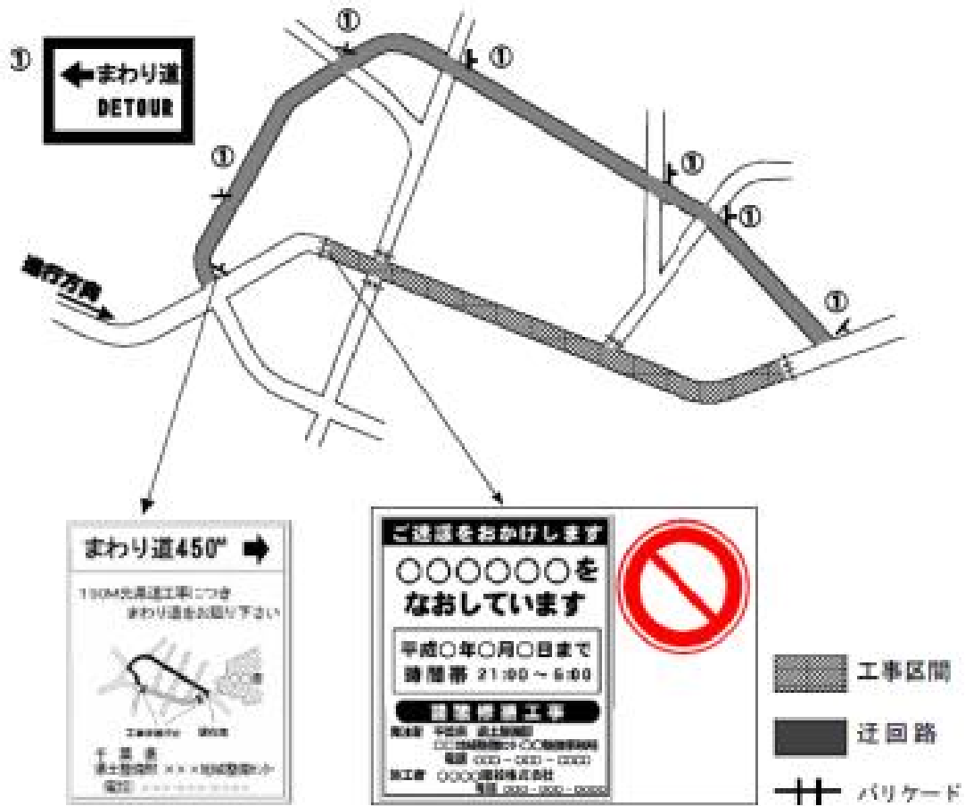
参考（３） 工事中迂回路の表示例（地方部の場合） （進行方向に対する標識の設置例を示す）
