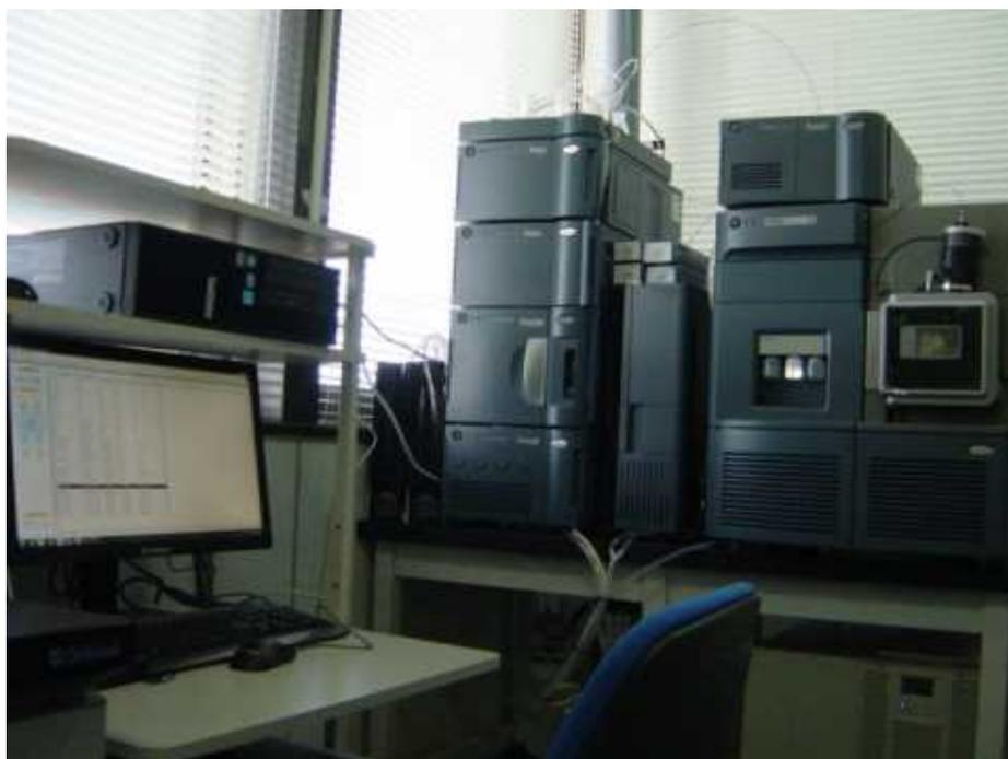
図1-7 高速液体クロマトグラフ・タンデム質量分析計
