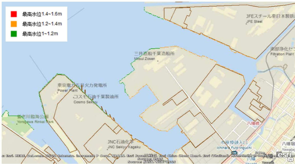
図 5. 4. 8-3 海岸における津波高（京葉臨海中中部地区、堤防なし）
