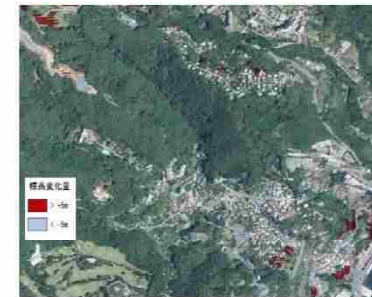
机上調査(DEM差分による方法)の例
