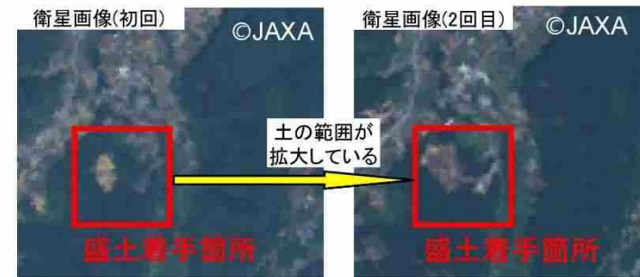
机上調査(衛星光学画像比較解析による方法)の例
